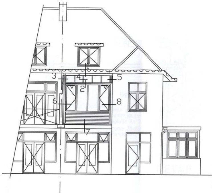
Afbeelding 3. Nieuwe achtergevel dubbel woonhuis Clematislaan 1. De afwijkende uitbouw op het balkon verstoort de bestaande architectonische samenhang.
